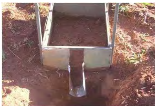
FIGURA 8. Parte inferior do simulador de chuva (calha coletora)
