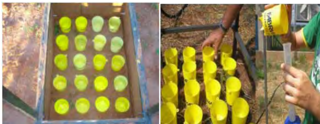
FIGURA 9. Realização do CUC em parcela a ser submetida à simulação de chuva.
