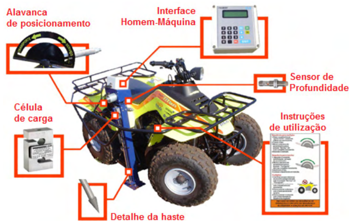
FIGURA 4. Penetrômetro eletrônico PNT2000/Motor acoplado ao quadriciclo.
