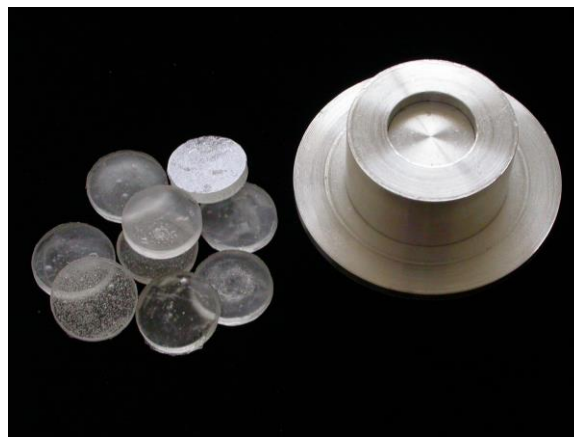
Figura 1. Matriz metálica e discos em resina acrílica
