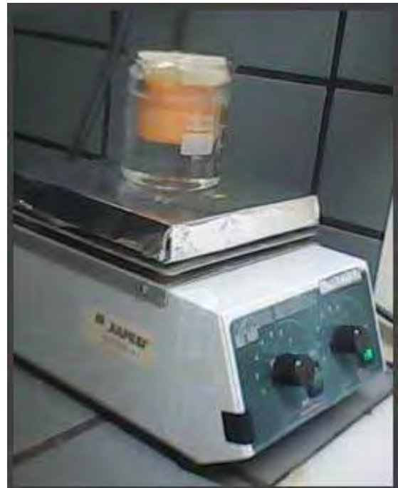
Fig. 14- Ilustra o reator para deposição de CdS por Banho Químico e coloração típica da solução quando é formado moléculas de CdS e reação terminada.
