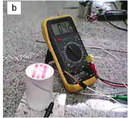
Fig. 16- Fotografia dos componentes do Sistema CSS. a) subsistema aquecedor de cerâmica com resistência de 10\Omega , b) subsistema aquecedor em processo de teste, c) Porta fonte e porta substrato feito de cerâmica para o sistema CSS e d) Disco de alumínio antes de ser montado no sistema CSS, e) O forno do sistema de deposição CSS para CdTe de cerâmica.
