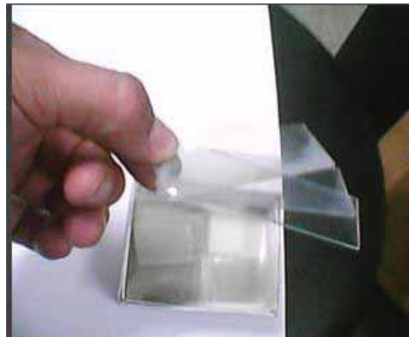
Fig. 13- Nesta figura estão sendo mostrados três filmes de óxido condutor transparente ( \text{SnO}_2:\text{F} ), depositados sobre vidro soda lime de microscopia pelo método de Spray a 450^\circ\text{C} .
