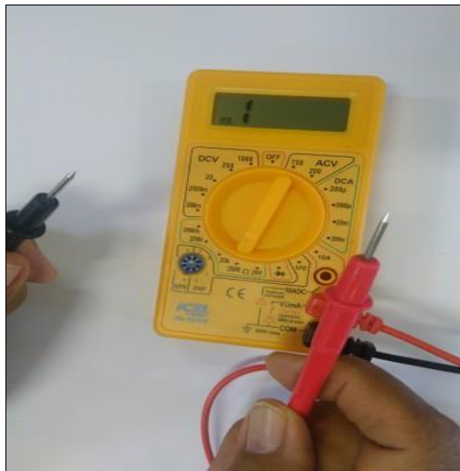
Figura 13- Sem medição da resistência
