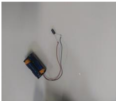
Figura 11- Capacitor sendo carregado
