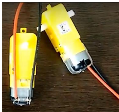
Figura 22 - Motores DC com fios soldados nos terminais
