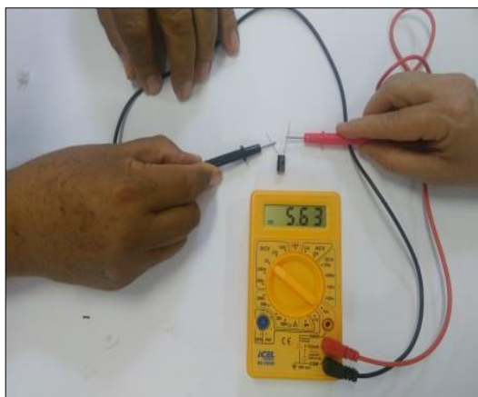
Figura 12 - Medição da carga do capacitor
