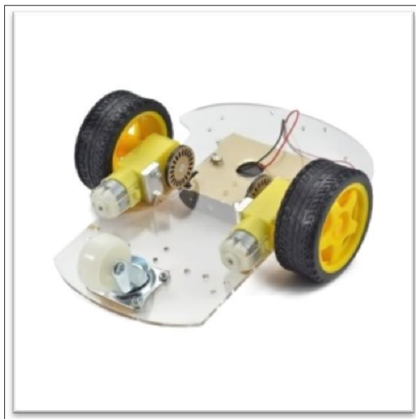
Figura 26 - Visão da montagem da face inferior da base do chassi
