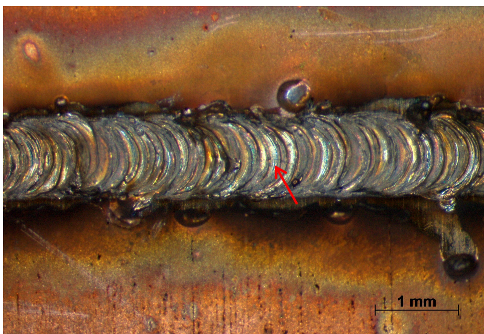
Figura 30 – Cordões de solda amostra Cu60
