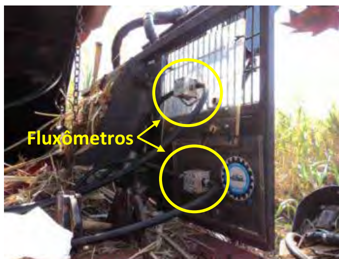
Figura 3. Fluxômetros volumétricos instalados na colhedora.
