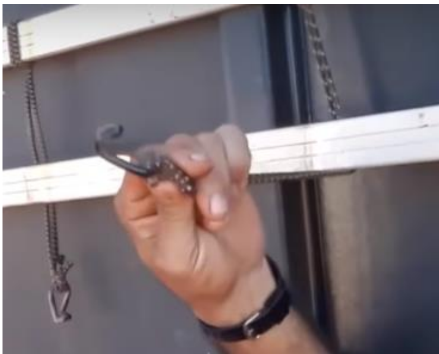
Figura 27: Borracha própria e gancho de travamento na lona. Fonte: Acervo do autor, 2022
