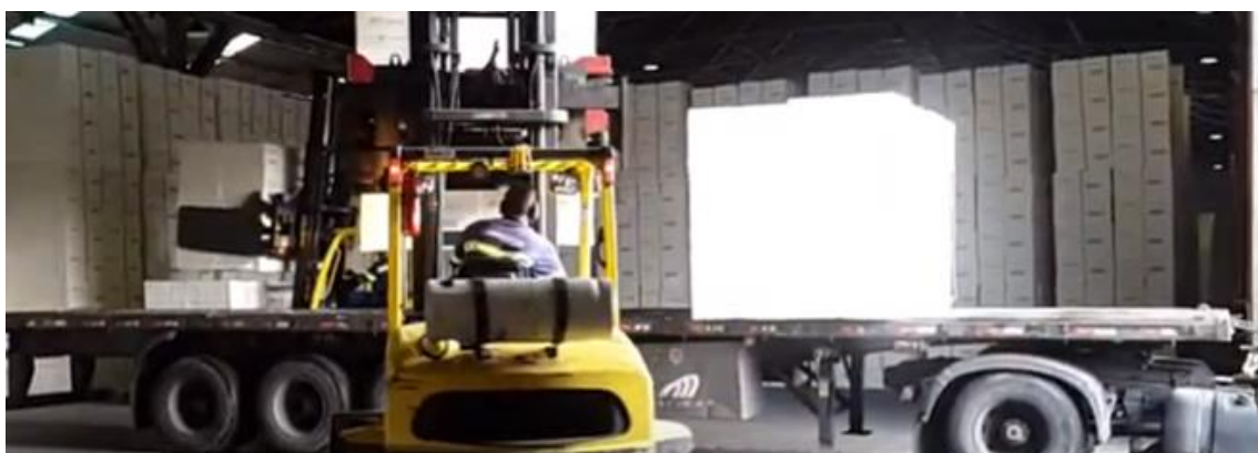
Figura 7: Carreta sem grade, inexistente e assoalho plano. Fonte: Acervo do autor, 2018.
