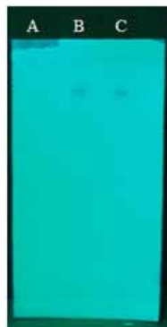
Figura 26. Perfil cromatográfico (A) do placebo, (B) da amostra e (C) da MP, ambos com Rf de 0,83 após visualização em câmara UVA a 365 nm, fase estacionária composta por sílica-gel e fase móvel contendo água purificada e álcool metílico, 70:30 (v/v) com pH ajustado para 3,0 com ácido acético glacial.
