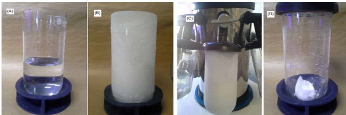
Figura 50. Ilustração das etapas da formação do complexo darunavir:β-CD em pó. (A) solução aquosa de darunavir e β-CD na proporção 1:1, (B) congelamento em nitrogênio líquido, (C) acoplamento do frasco no liofilizador e (D) possível complexo de inclusão darunavir:β-CD.
