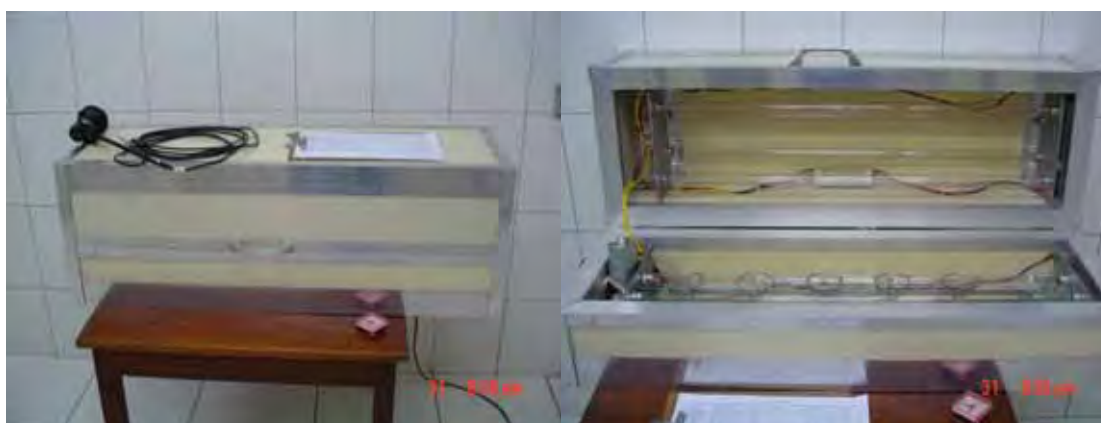
Figura 3. Equipamento com luzes ultravioletas utilizado para desinfecção dos ovos.
