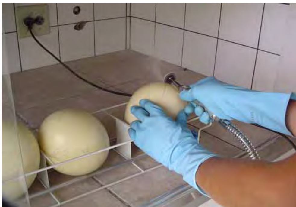
Figura 5 - Utilização da caneta odontológica para a retirada das amostras.
