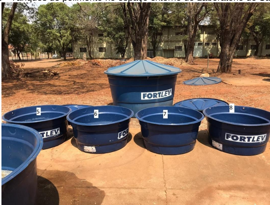
Figura 16 - Tanques de polimento no espaço externo do Laboratório de Saneamento
