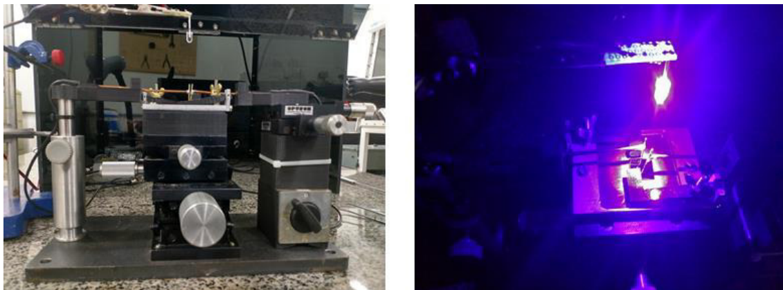
Figura 3.12: Foto do sistema utilizado para caracterizar os TFTs sob a influência de radiação UV.
