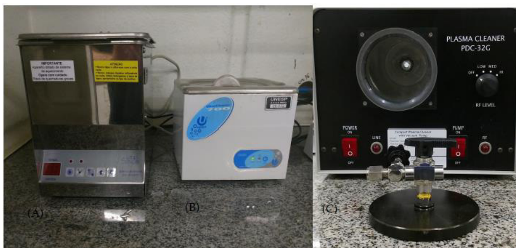
Figura 3.3: Equipamentos utilizados no procedimento de limpeza dos substratos (A) LimpSonic; (B) Unique-UltraCleaner 70, (C) Plasma Cleaner PDC – [32G].
