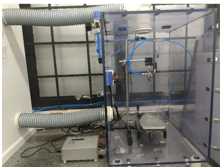
Figura 3.7: Foto do sistema de deposição por spray pirólise .
