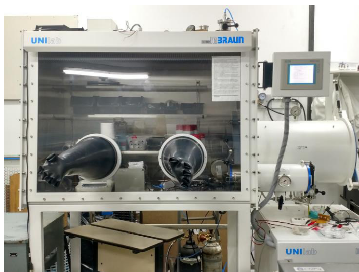
Figura 3.13: Equipamento utilizado para o controle de atmosfera durante as medidas elétricas- Glovebox Workstation MBUnilab 1200/780.
