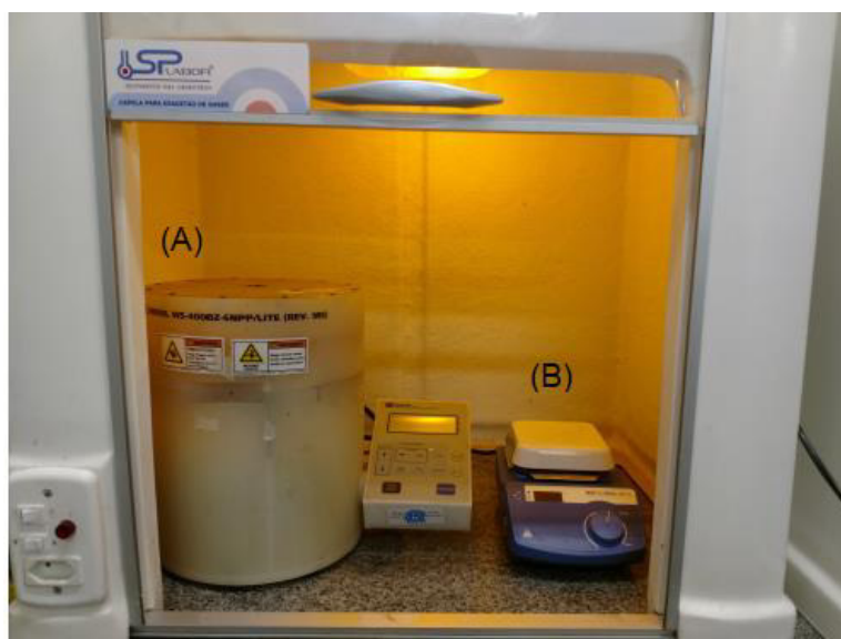
Figura 3.5: Equipamentos utilizados para a construção da camada semicondutora pela técnica de spin coating (A) Spinner – Laurell Technologies Corporation; (B) Placa de aquecimento- ICA-C-MAG HP 4.
