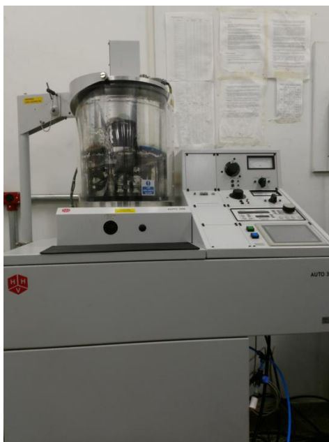
Figura 3.2: Evaporadora utilizada para a construção dos contatos metálicos – HHV Ltd-modeloAuto306 Lab Coater.
