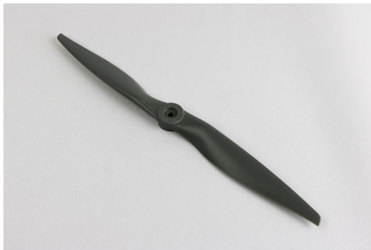
Figura 39 – Foto da hélice APC 13X4
