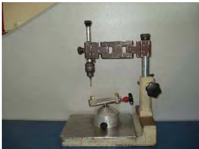
Figura 3 – Delineador onde foi acoplado o motor para realização das perfurações perpendiculares.
