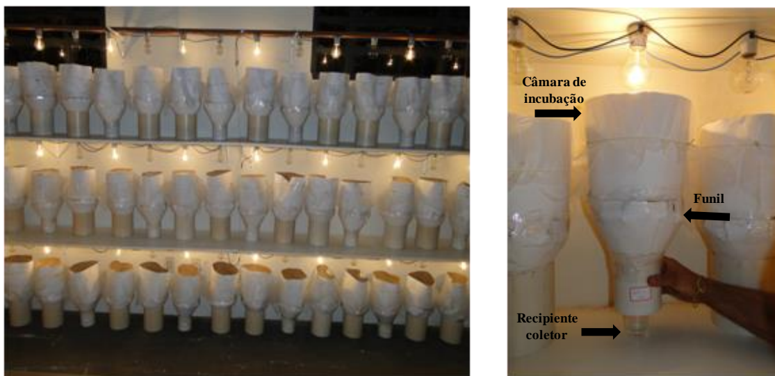
Figura 12. Bateria de funis de Berlese-Tülgren utilizados para extração da fauna de serapilheira.
