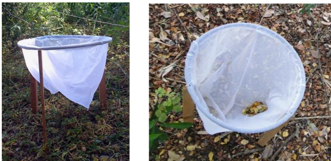
Figura 5. Coletores cônicos para a coleta de serapilheira instalados no Sítio 2, Fazenda Edgardia, Botucatu, SP.
