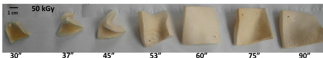
Figura 2.8. Exemplo de uma cinética de espumação de uma amostra irradiada a 50 kGy.
