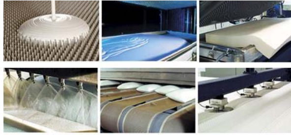
Figura 3.45. Algunas etapas de fabricación y productos obtenidos mediante los métodos Dunlop y Talalay.
