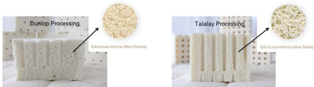
Figura 3.48. Comparación de la estructura celular en espumas de látex fabricadas por el método Dunlop y Talalay.
