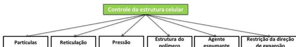
Figura 2.1. Mecanismos de controle da estrutura celular em espumas poliméricas.
