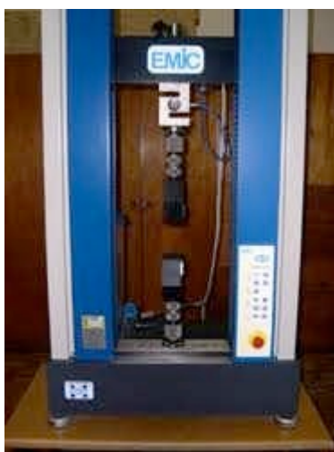
Figura 5 - EMIC DL 2000, máquina de ensaios mecânicos
