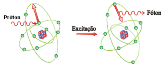
Figura 5 - Excitação atômica ou molecular devido à interação do próton com a matéria
