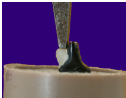
FIGURA 6 – Corpo-de-prova com o material restaurador e o cinzel metálico em posição.
