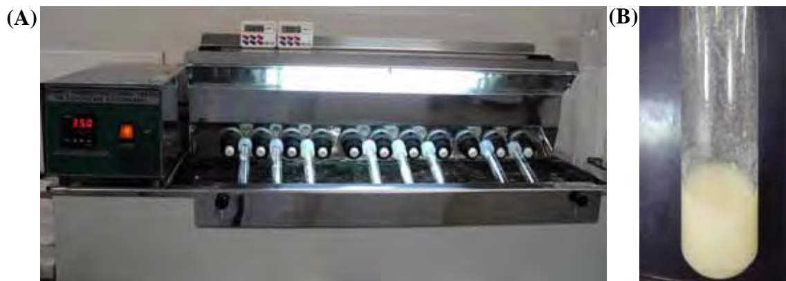
Figura 9. Banho termostático para testes de coalhos e coagulantes (A); Tubo de ensaio coagulado (B).
