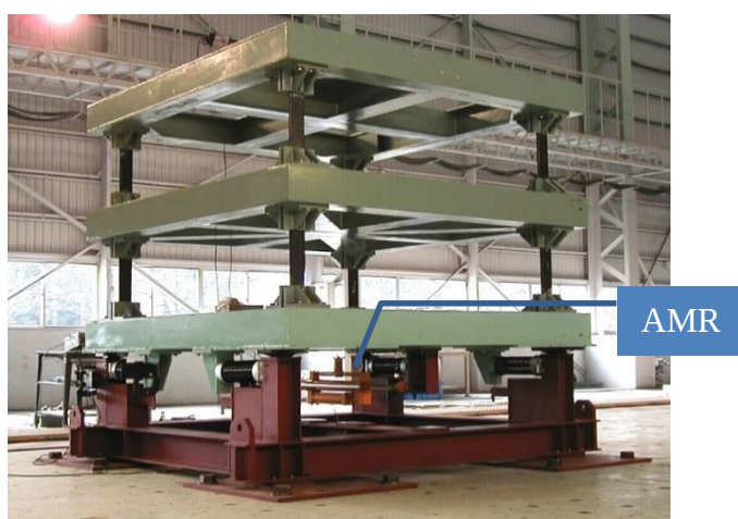
Figura 4 – Sistema de isolamento sísmica com amortecedor de viscosidade controlada usando fluido magneto-reológico (MR).
