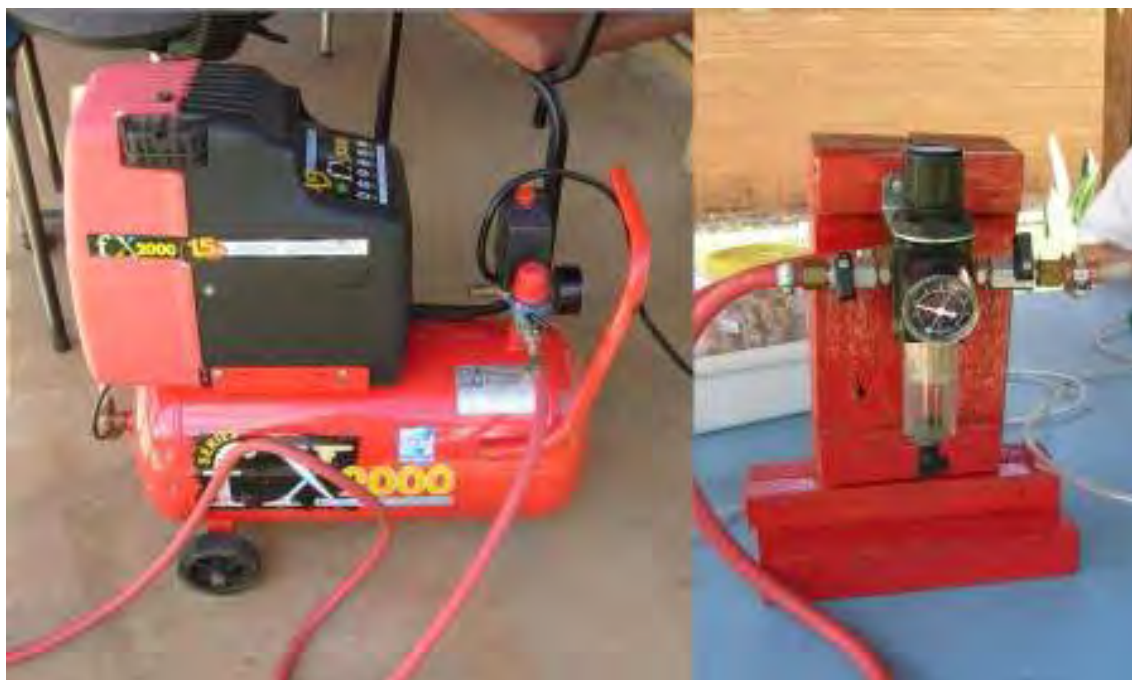
Figura 7. Equipamento desenvolvido para nebulização em ninhos artificiais. A: compressor portátil, B: Regulador da vazão.
