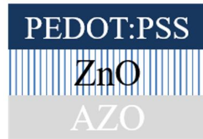
Figura 22 – Arquitetura do fotodiodo Schottky produzido no LaDSOr.
