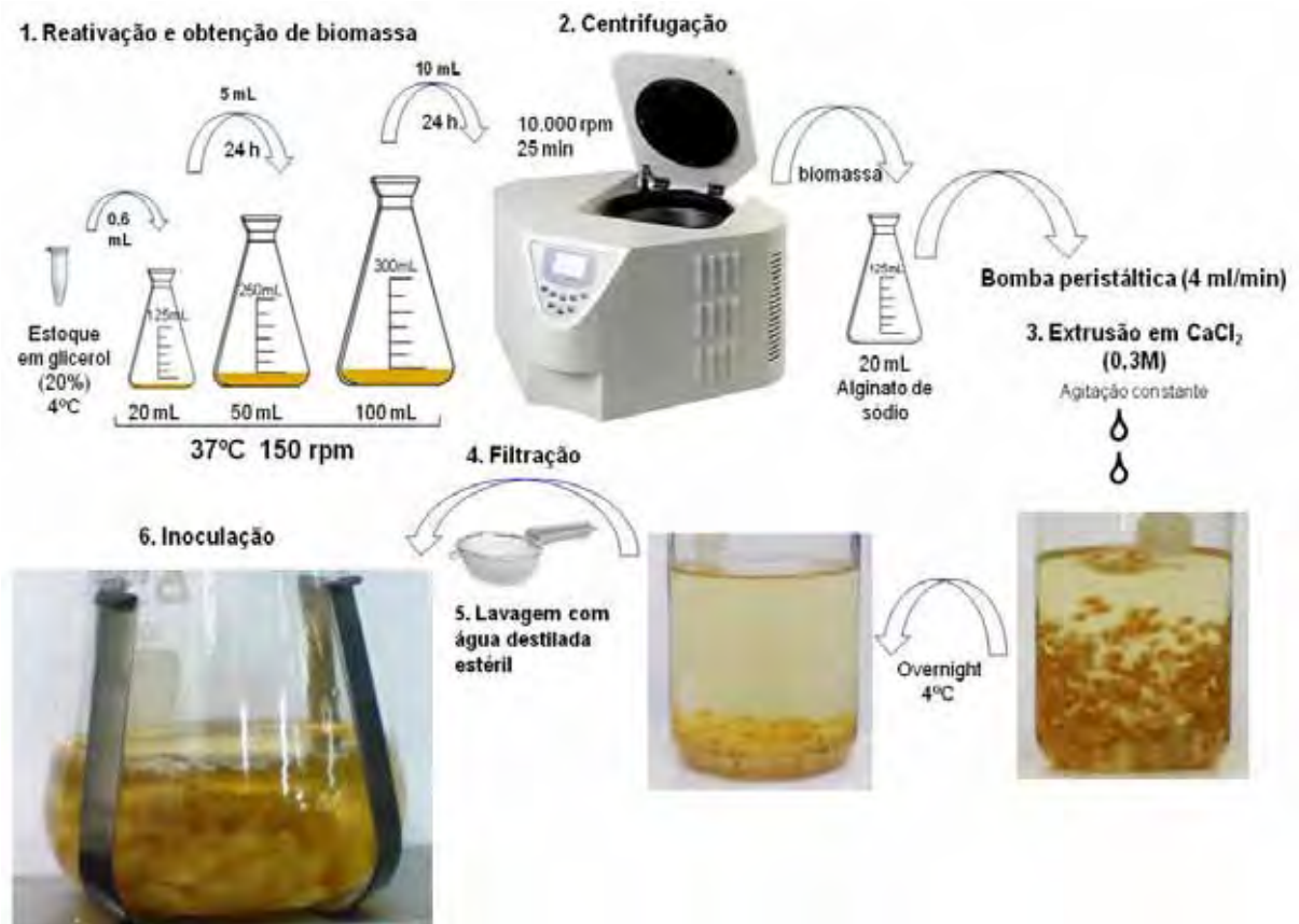
Figura 10. Esquema geral da imobilização por aprisionamento em alginato de cálcio.
