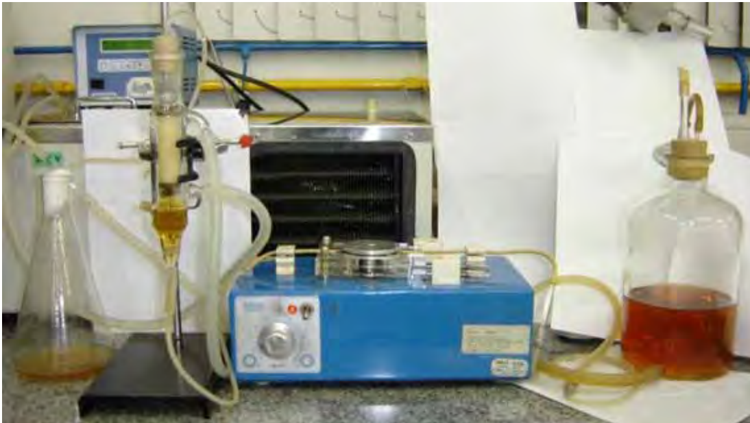
Figura 15. Sistema contínuo de fermentação com reator de leito empacotado.
