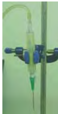
Figura 11. Extrusora utilizada para a imobilização das células em alginato
