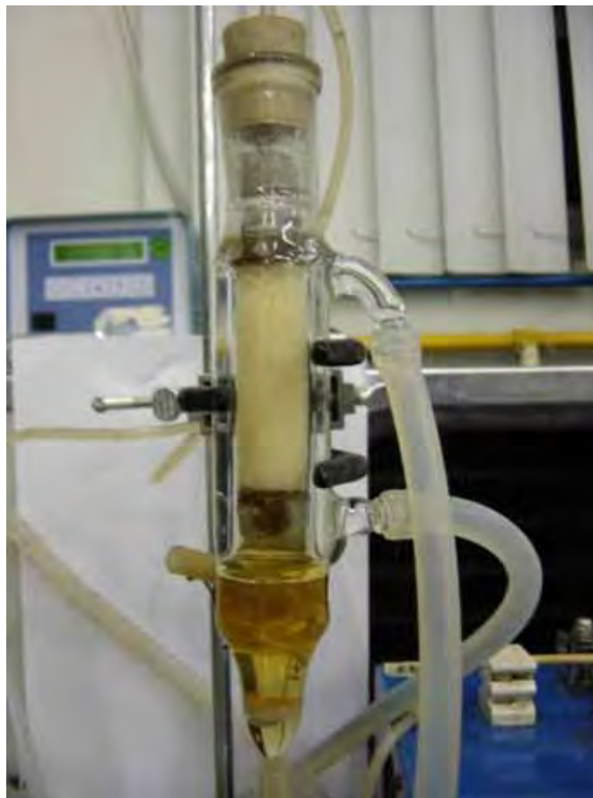
Figura 16. Detalhe do reator de leito empacotado com células imobilizadas.
