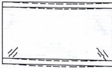
Figura 24 – Fissuras inclinadas por deformabilidade excessiva
