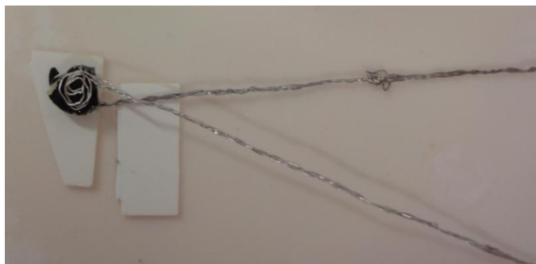
Figura 4.4. Corpo de prova utilizado nas medidas de Espectroscopia de Impedância Elétrica.
