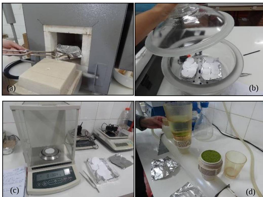
Figura 16. Obtenção do Material em Suspensão (forno Mufla (a), dessecador (b), pesagem (c), filtragem (d))
