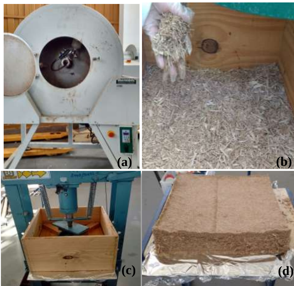
Figura 16: Pré-prensagem e Colchão formado.
