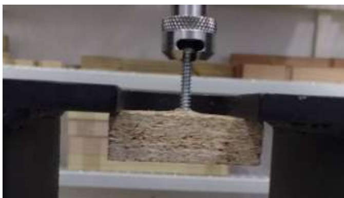
Figura 24: Arrancamento de parafuso tipo face (superfície).
