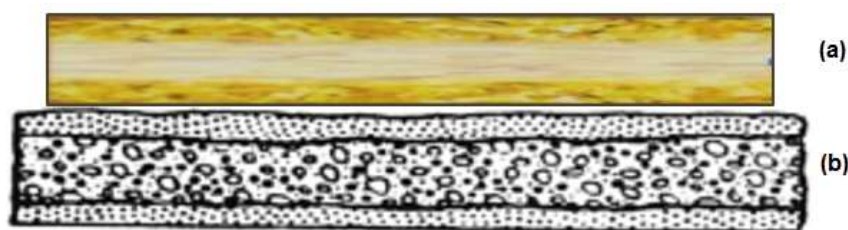
Figura 2: a) Camadas de um painel MDP; b) Disposição das partículas no painel MDP
