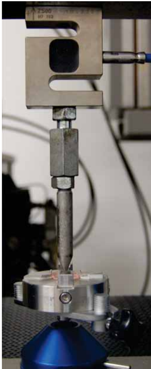
Figura A4: Corpo de prova posicionado na máquina de ensaios mecânicos (EMIC DL 2000).
