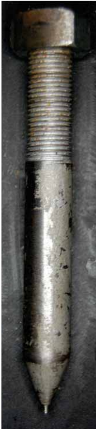
Figura A6: Haste com 1,3 mm de diâmetro utilizada para a realização do teste push-out.
