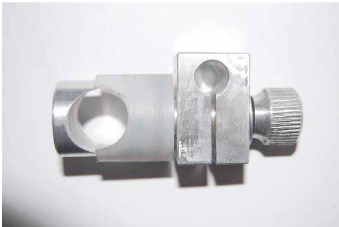
Figura A2: Dispositivo para adaptação do aparelho de ultrassom ao delineador
