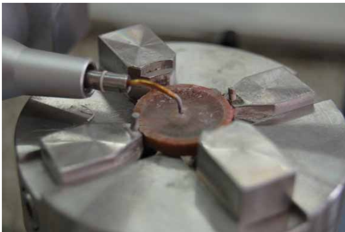
Figura A3: Corpo de prova posicionado na base do delineador, com a ponta ultrassônica acoplada.
