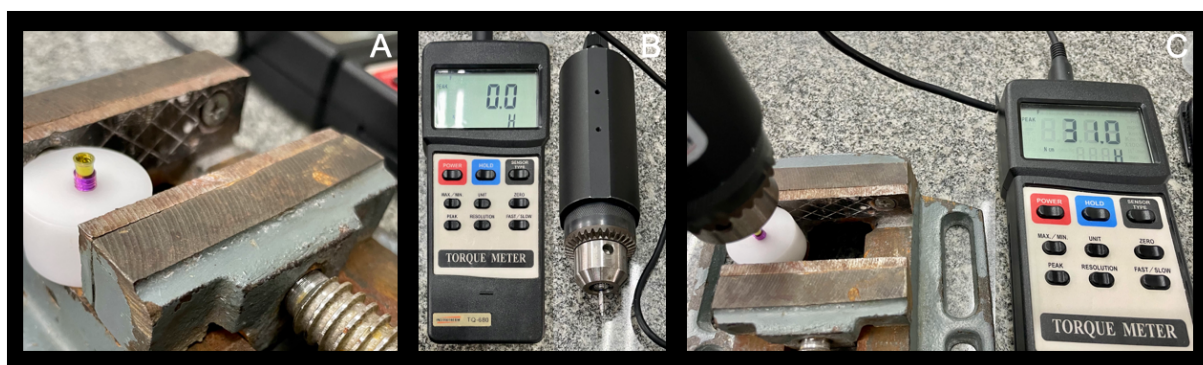
Figura 10 – Elementos utilizados para os testes de torque
