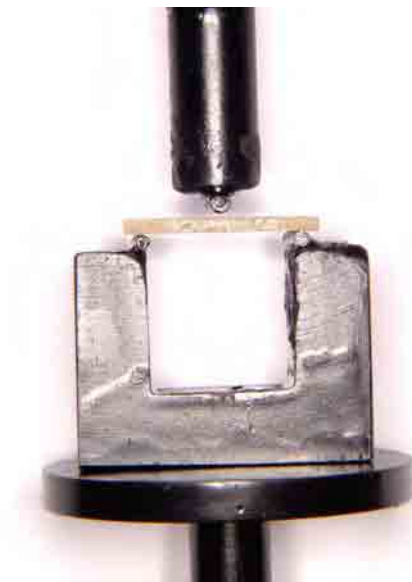
FIGURA 5 - Dispositivo empregado para o ensaio de resistência à flexão em três pontos.
