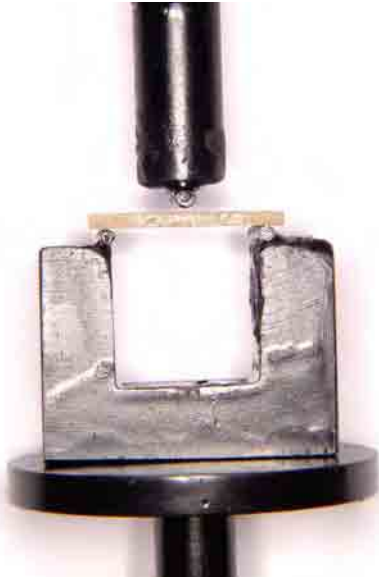
FIGURA 7 - Ciclagem mecânica sem apoio adicional no espécime.
