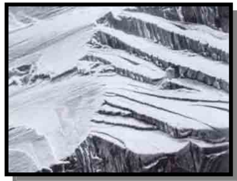
FIGURA 10 - Planos de clivagem, em padrão de escada. Liga metálica Ni-Cr-Mo-Ti-Al-Fe. Aumento estimado de 1000X. (ASM Handbook – Fractography 23 , 1992)
