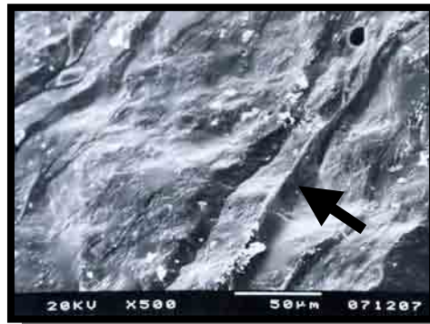
FIGURA 14 - Planos de clivagem, em padrão de escada (seta). Grupo de ciclagem mecânica 30% da tensão máxima, com apoio adicional, Aumento de 500x.
