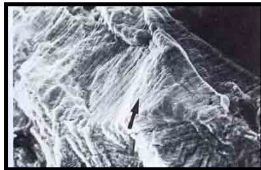
FIGURA 12 - Estrias (seta). Liga metálica Ni-C-Cr-Mn-Ti-Al. Aumento estimado de 3200X (ASM Handbook – Fractography 23 , 1992)
