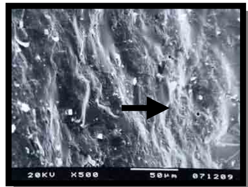
FIGURA 18 - Estrias (seta). Grupo de ciclagem mecânica 60% da tensão máxima, com apoio adicional, total. Aumento de 500x
