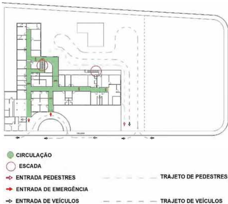
Figura 23 – Circulação interna e externa de pedestres no pavimento térreo e circulação externa de veículos.
