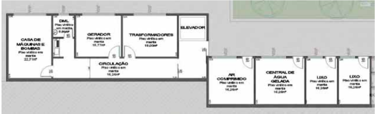
Figura 55 – Planta do setor de infraestrutura predial
