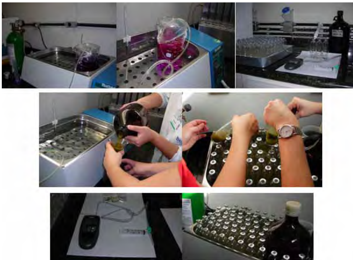
Figura 19. Procedimento realizado para determinação da digestibilidade in vitro pela técnica semi automática de produção de gases
