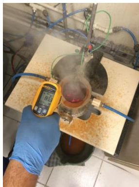
Figura 13. Verificação de temperatura no sistema eletrolítico em operação.
