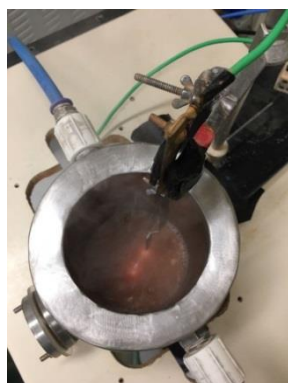
Figura 6. Foto do sistema eletrolítico em operação.
