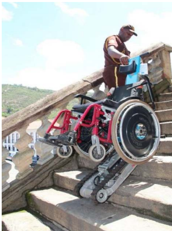
Figura 16 – Mecanismo de transporte inclinado para cadeira de roda Museu da Inconfidência, Ouro Preto/MG
