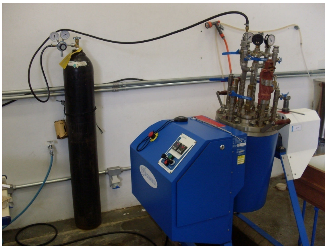
Figura 14 – Autoclave rotativa com reatores individuais recebendo gás oxigênio para o início da deslignificação.
