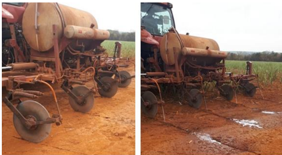
Figura 17 – Aplicador de inseticidas de quatro linhas para soqueira na cana-de-açúcar. (Foto: Usina São Martinho)
