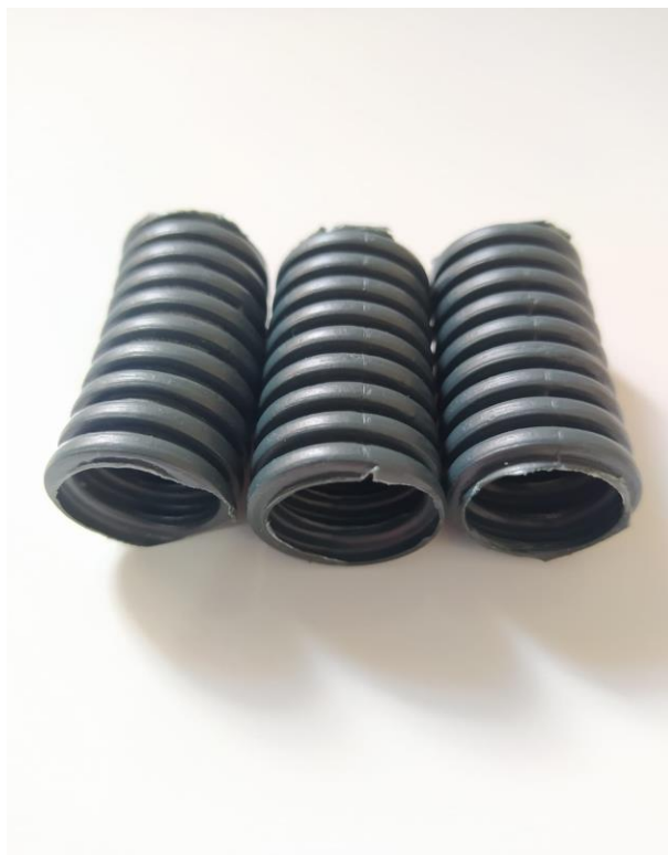
Figura 7. Material de meio suporte (anel de eletroduto corrugado) utilizado nos reatores anaeróbios de leito fixo e alta taxa - RAHLF.
