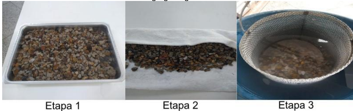
Figura 12: Etapas envolvidas na determinação da massa específica aparente das amostras de agregado graúdo
