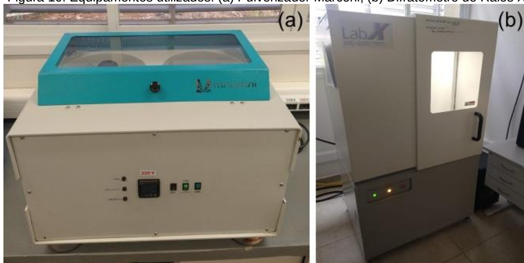
Figura 10: Equipamentos utilizados: (a) Pulverizador Marconi; (b) Difratorômetro de Raios X
