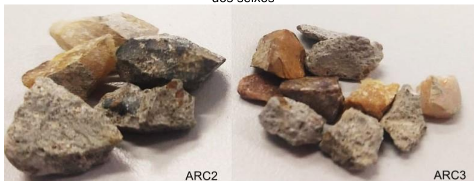
Figura 23: Aspecto das amostras ARC2 e ARC3 com poros aparentemente formados em torno dos seixos
