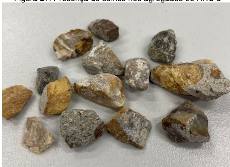
Figura 17: Presença de seixos nos agregados de ARC 3
