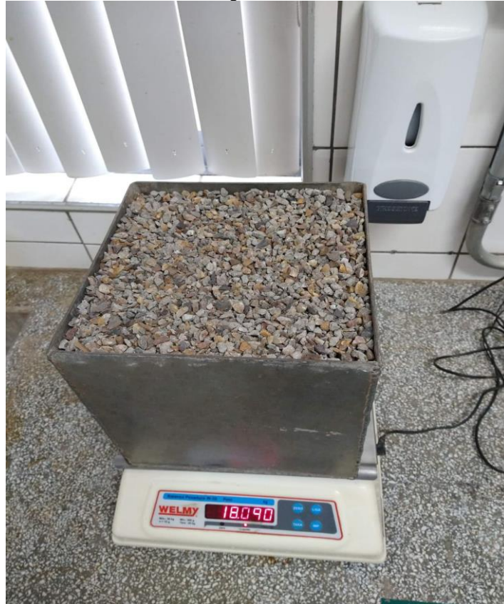
Figura 13: Processo de adensamento para determinação da massa unitária do agregado graúdo
