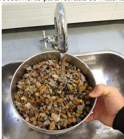
Figura 11: Procedimento para retirada do material pulverulento
