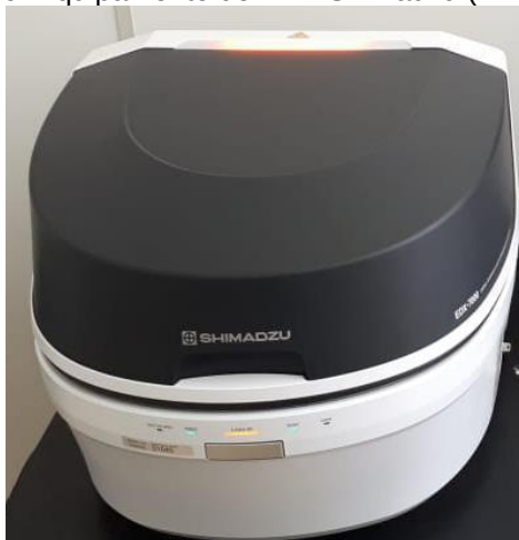
Figura 9: Equipamento de FRX Shimadzu (XRF-7000)
