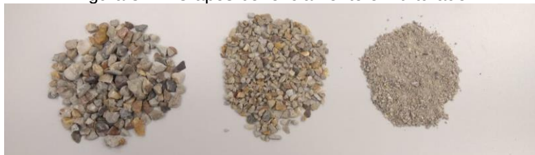
Figura 8: ARC após beneficiamento em triturador
