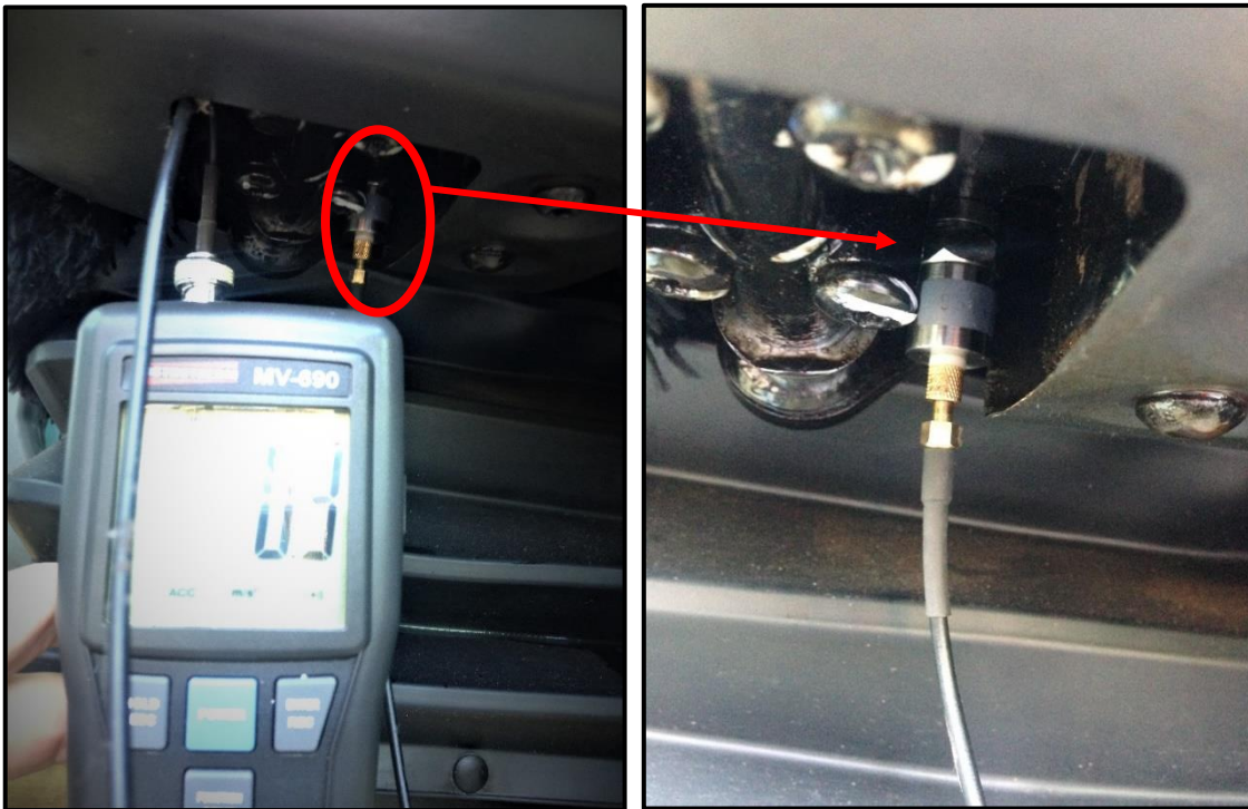
Figura 9 - Detalhe do acelerômetro instalado no Feller Buncher e na Garra Traçadora
