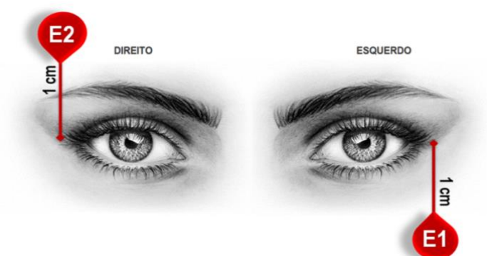
Figura 8 – Diagrama esquemático mostrando o método e posicionamento dos eletrodos E2 (direito) e E1 (esquerdo) para os registros de EOG.
