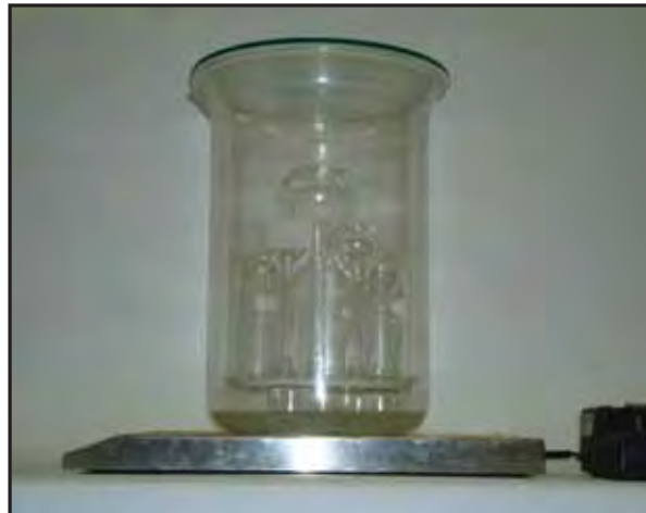
Figura 3 – Sistema de limpeza de vidraria utilizada na quantificação de mercúrio.
