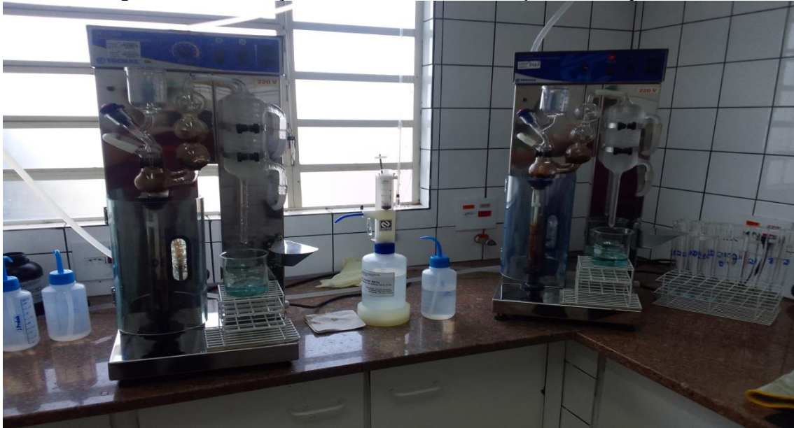
Figura 13. Destilação do N em destilador tipo micro Kjeldahl
