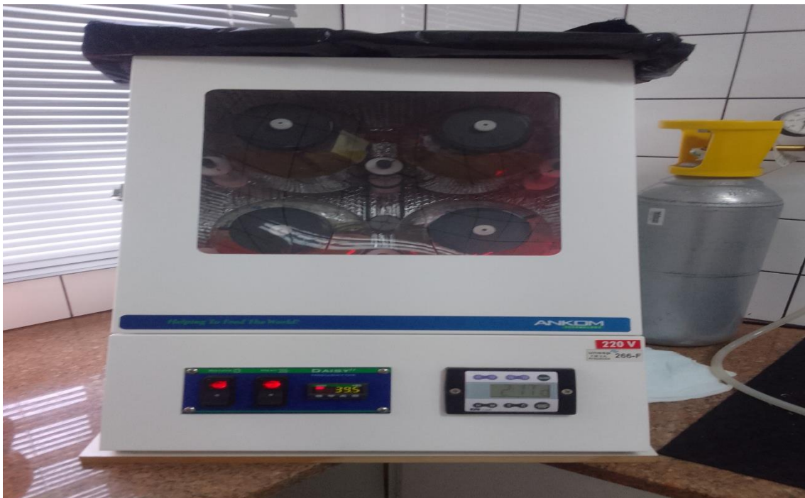
Figura 14. Incubador Ankom Daisy II utilizado para determinação da digestibilidade in vitro da matéria seca
