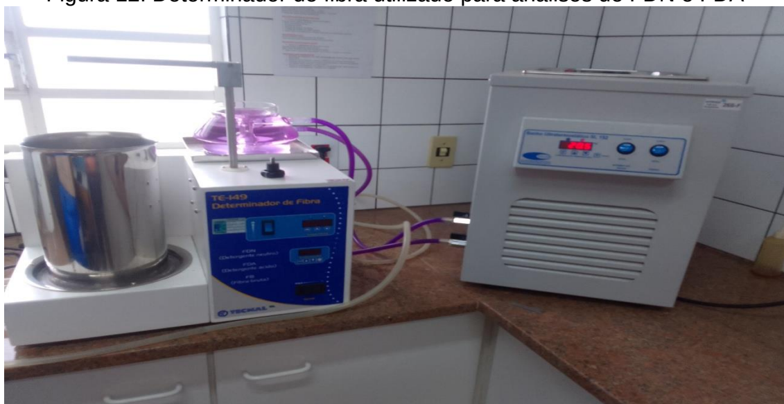
Figura 12. Determinador de fibra utilizado para análises de FDN e FDA
