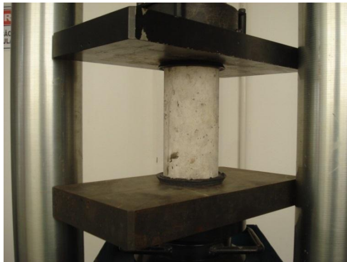
Figura 6. Exemplo de ensaio de resistência à compressão axial
