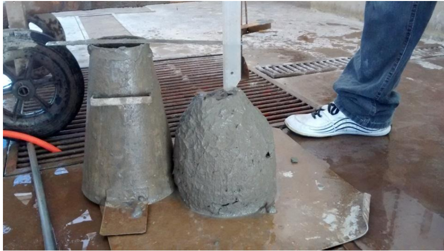
Figura 8. Ensaio de Abatimento de Tronco de Cone
