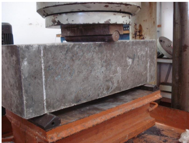
Figura 7. Ilustração do ensaio de resistência à tração na flexão
