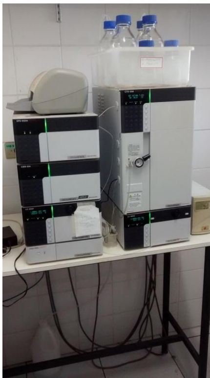
Figura 15. Cromatógrafo Líquido de Alta Eficiência utilizado para análise de TPMA
