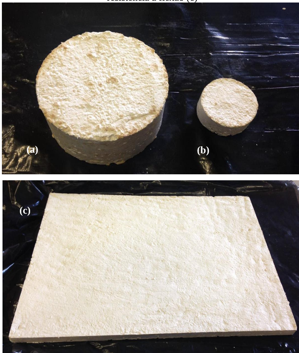
Figura 17 – Corpos de prova para ensaios de absorção sonora (a), condutividade térmica (b) e resistência a flexão (c)
