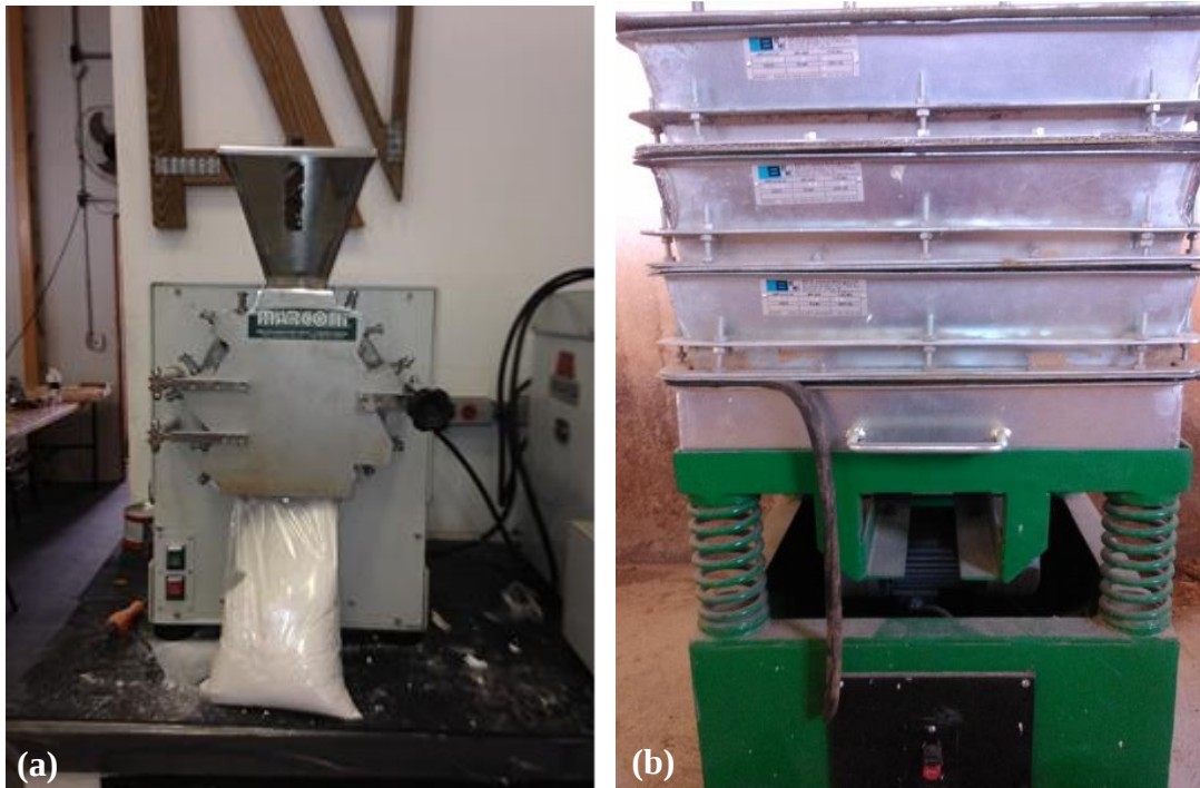
Figura 13 – Etapas de (a) moagem e (b) peneiramento do resíduo de gesso acartonado
