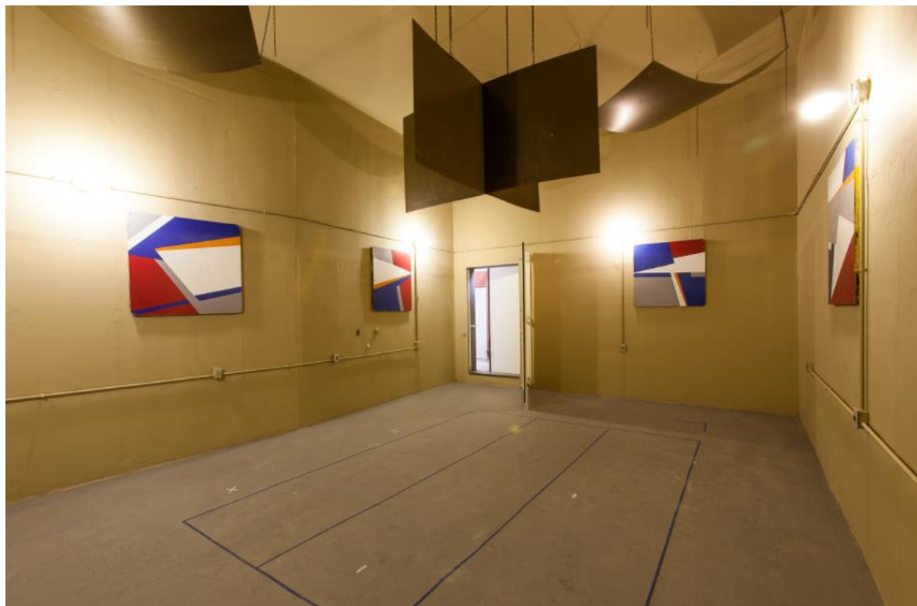
Figura 7 – Câmara reverberante sem amostra para ensaio
