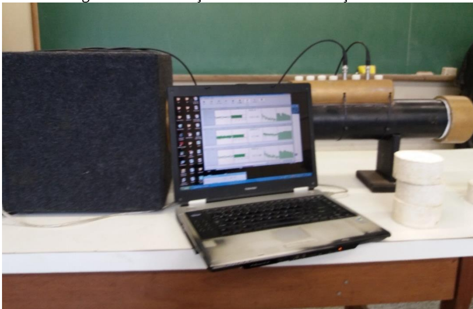
Figura 18 – Realização do ensaio de absorção sonora
