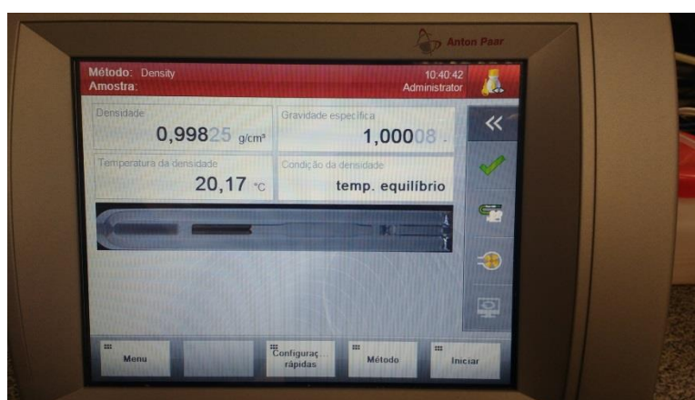
Figura 6. Leitura de água destilada realizada com o densímetro.
