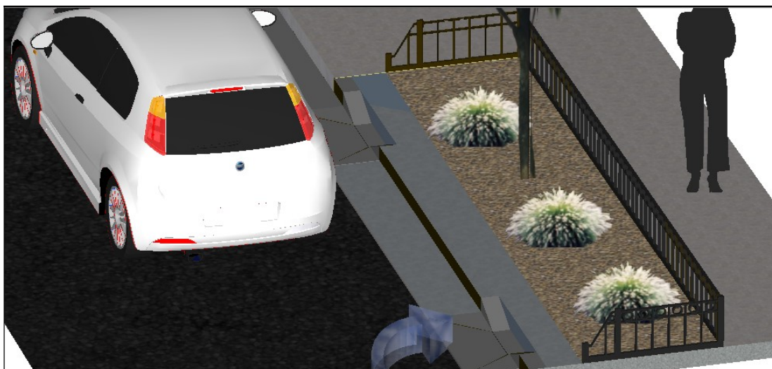
Figura 48- Proposta para jardim de chuva no passeio público. Fonte: esquema projetado pela autora. 2020.
