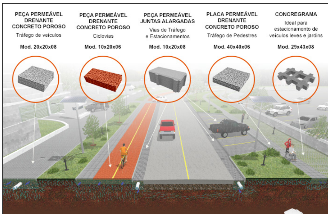
Figura 8- Tipologia com diferentes aplicações de pisos permeáveis 4
