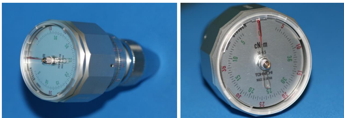
Figura 10: Medidor analógico de torque (Tonichi BTG36CN-S).
