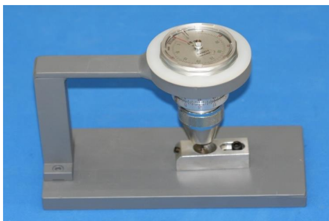
Figura 11: Dispositivo com corpo-de-prova e medidor analógico de torque.
