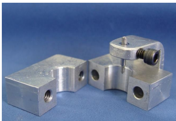
Figura 2 - Matriz metálica utilizada para embutir os implantes osseointegráveis.
