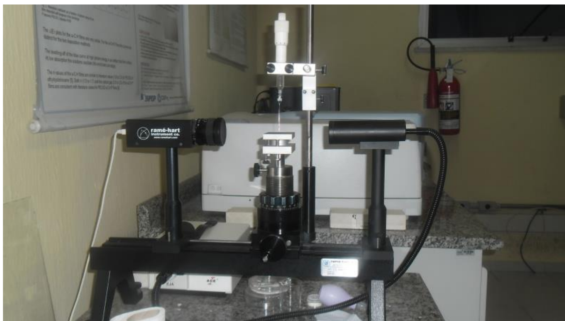
Figura 3.4.3.1 - Goniômetro RAMÉ-HART, modelo 100-00
