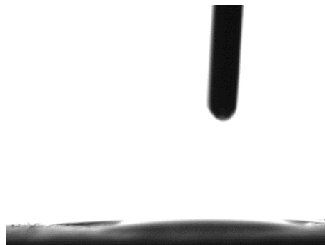
Figura 4.1.1.10 – Imagem onde o líquido molha a superfície do sólido (WCA = 0°)
