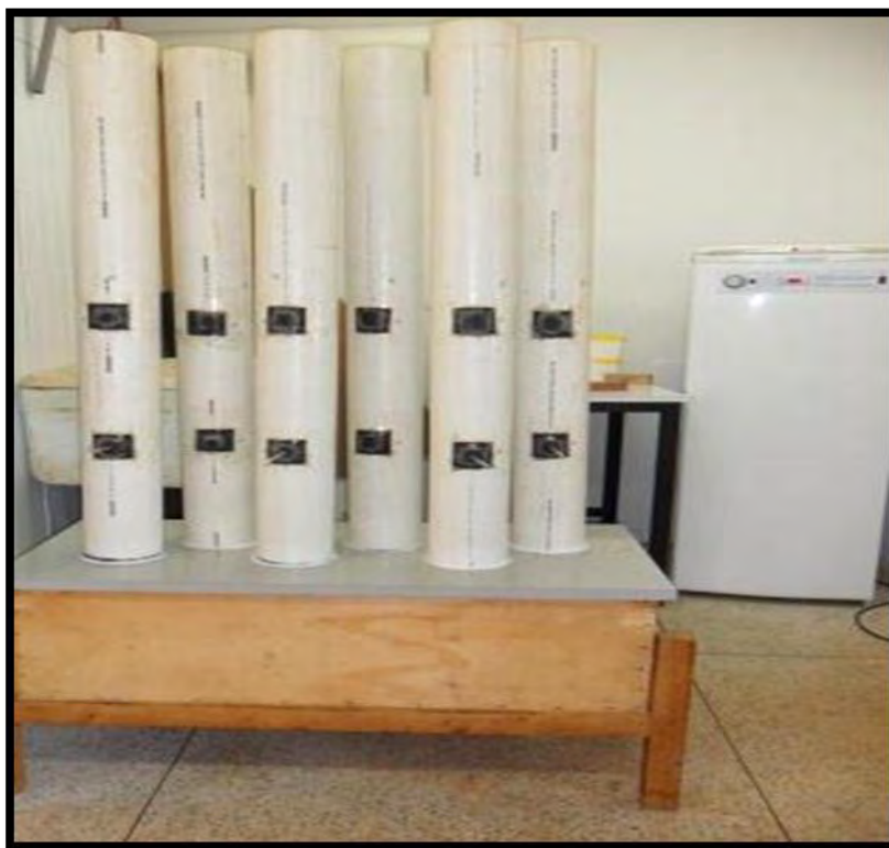
Figura 3. Protótipo utilizado para secagem do crambe com ar natural, no Laboratório de Processamento de Produtos Agrícolas, Departamento de Engenharia Rural, FCA, UNESP, Botucatu-SP.
