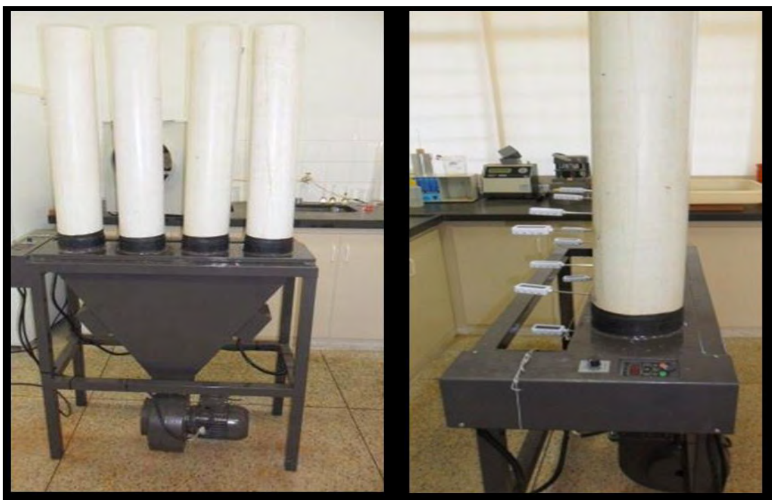
Figura 2. Protótipo utilizado para secagem do crambe com ar aquecido, no Laboratório de Processamento de Produtos Agrícolas, Departamento de Engenharia Rural, FCA, UNESP, Botucatu-SP.
